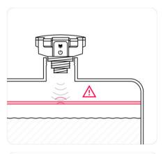
Querverstrebungen, Verrohrungen oder Vertiefungen am Tank, die innerhalb des Ultraschallmesskegels des Gerätes liegen, können zu einer Verfälschung der Messung führen.
